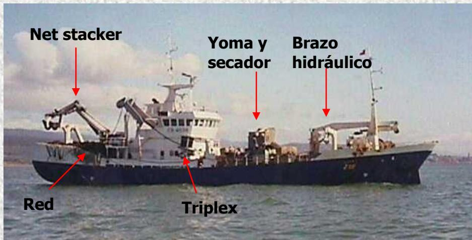
de popa de la red es subida a bordo mediante el triplex o power block. Una vez que la red ha sido virada casi en su totalidad, y la captura se encuentra en el copo atrincado a una banda de la nave, se instala la yoma para succionar a bodega la captura lograda. En la búsqueda de cardúmenes, una parte de la flota artesanal utiliza FADs (Fish Aggregating Devices, por sus siglas en inglés) para concentrar a las especies a capturar, siendo los FADs más comunes cajas de madera lanzadas al agua.
