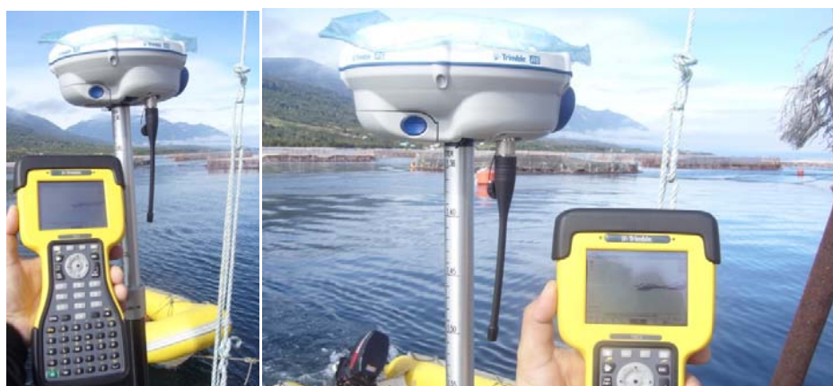
Figura 4. GPS Geodésico en modalidad RTK
