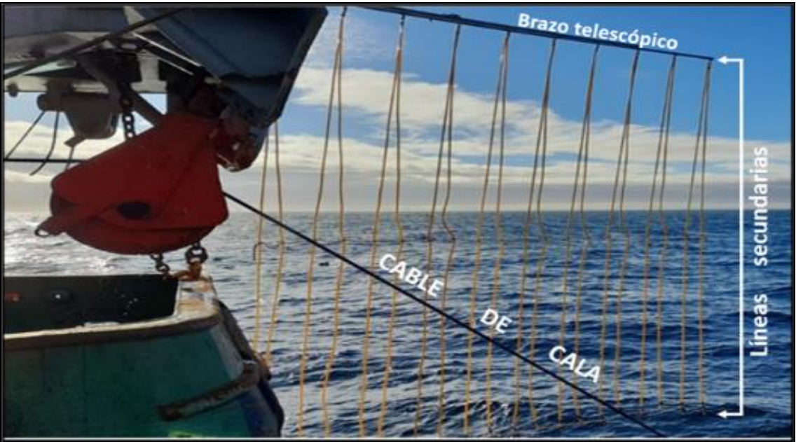
Figura 5. Sistema Bird Baffler ( BB ) para reducir las colisiones de las aves marinas con los cables de cala. Fuente: ATF-Chile.
