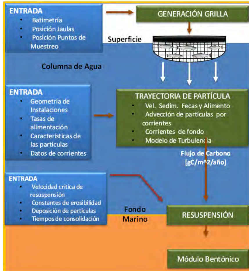
Figura 8 - Esquema de integración de los módulos de utilizados por el modelo DEPOMOD®.
