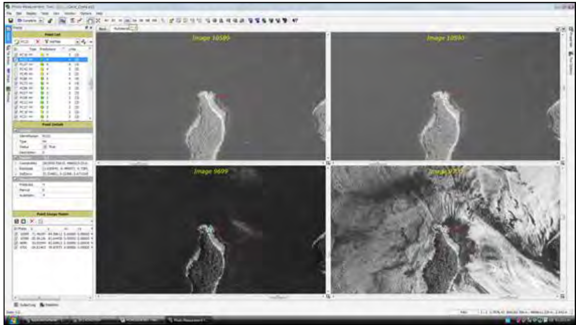
Figura 10. Medición de Puntos de Control fotogramétrico, en software Inpho.
