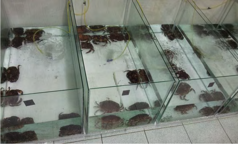
Figura 1. Vista de acuarios experimentales de 205 L de vidrio, con 100 L de agua de mar filtrada 5um-UV, con burbujeo, para la aplicación de los tratamientos.
