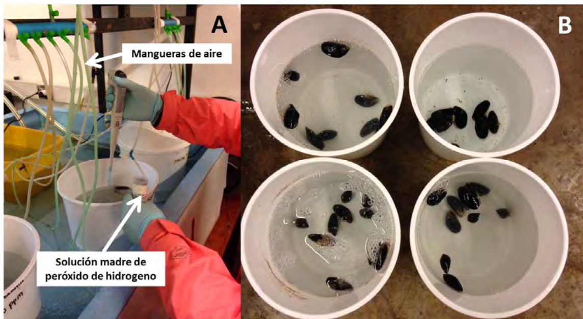
3Figura 3. A) Adición de Peróxido de Hidrogeno en las bateas experimentales durante los tratamientos. B) Diseño experimental con 3 réplicas para cada concentración (50, 100, 300, 750, 1500, 2000, 3000 ppm) más una batea control [sin H 2 O 2 ]. Cada batea contuvo 10 animales en un volumen de 7 litros de agua de mar filtrada. Para la exposición con el compuesto azametifos se utilizó el mismo diseño (concentraciones utilizadas = 1, 3, 10, 30, 100, 300, 500 ppb).
