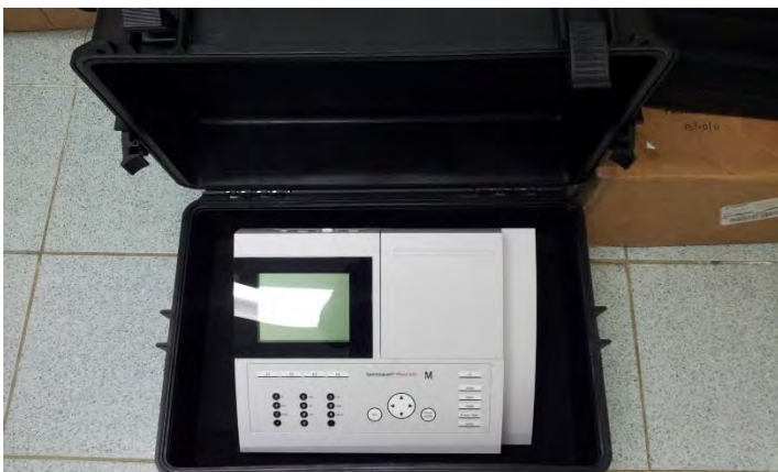
Figura 10. Espectrofotómetro para mediciones de peróxido en terreno.
