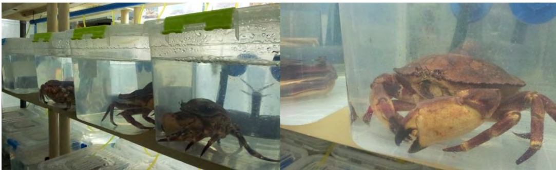
Figura 4. Vista de sistema de mantención con 144 acuarios plásticos transparentes que permiten evaluar la conducta de los animales experimentales. Los acuarios están ubicados en 4 niveles correspondientes a los tiempos de evaluación post-tratamiento (24 h (nivel superior), 48 h (segundo nivel), 72 h (tercer nivel) y 96 h (nivel inferior)). En cada nivel de cada uno de los 3 racks hay 3 réplicas de las cuatro concentraciones experimentales correspondientes
