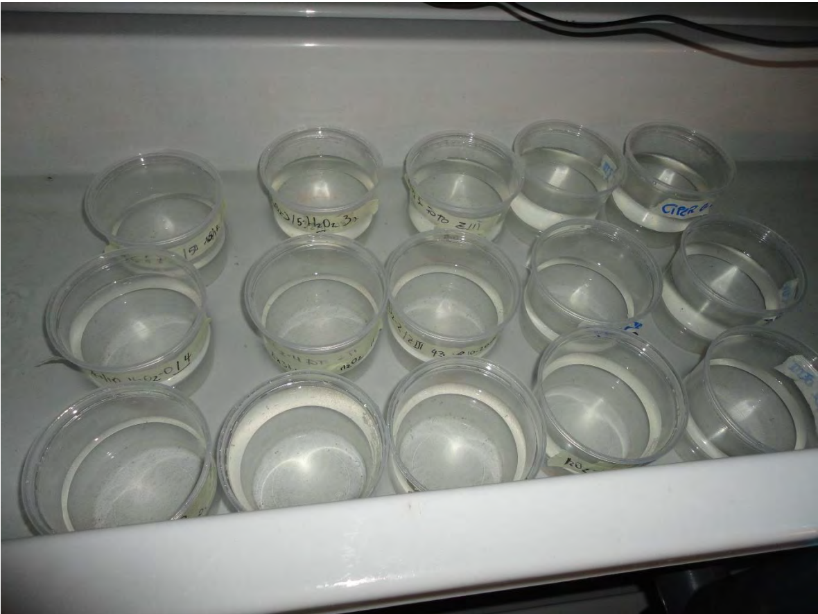
Figura 5. Vista de recipientes para exposición a larvas de jaiba y para su posterior seguimiento en baño termorregulado
