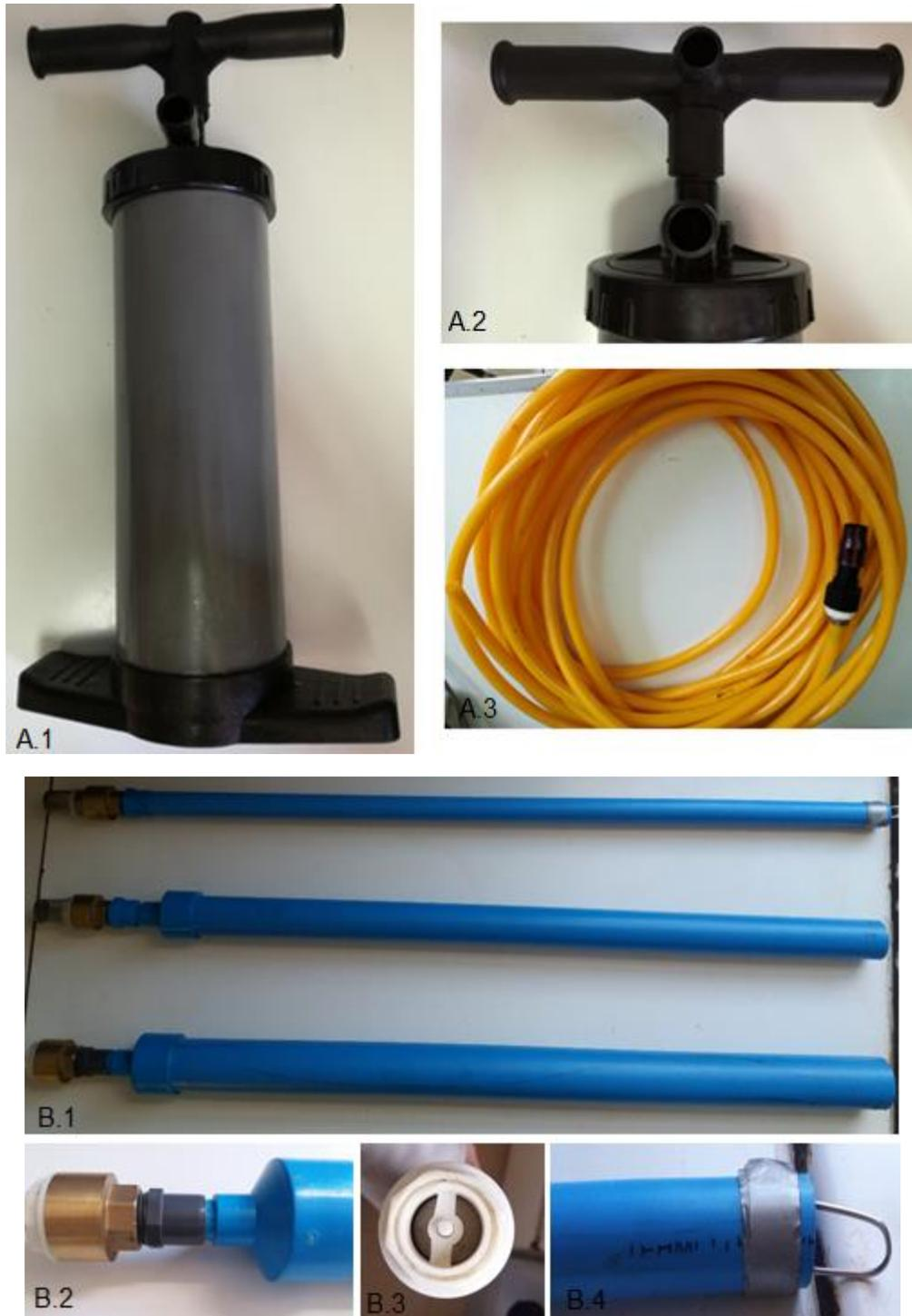
Figura 14. Bomba manual A1 y A2, manguera A3, botellas de diferentes tamaños B1, sistemas de cierre asociados a las botellas B2, B3 y B4.
