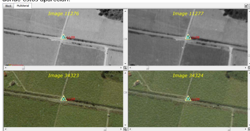
Figura 14. Medición de Puntos de Control fotogramétrico, en software Inpho.
