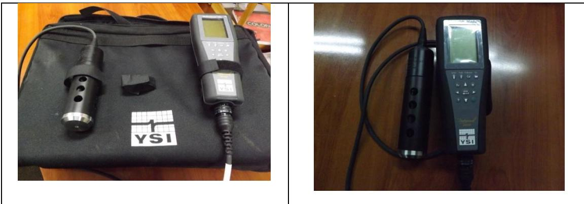
**Figura 8.** Equipo portátil multiparamétrico YSI professional plus
