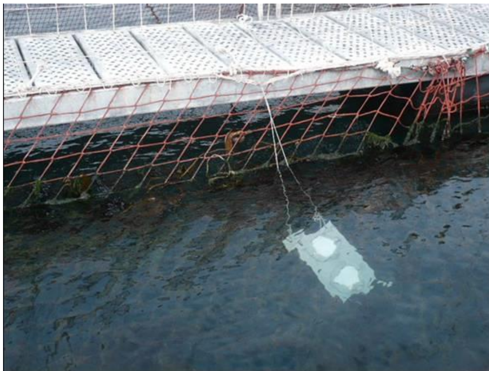
Figura 3. Despliegue de muestreadores pasivos en campo.
