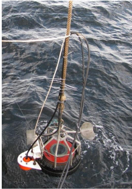
Figura 10.2. Transductores sumergibles split beam de 38 y 120 KHz (modelos ES38DD y ES120-7) acoplados a una estructura de acero inoxidable.
