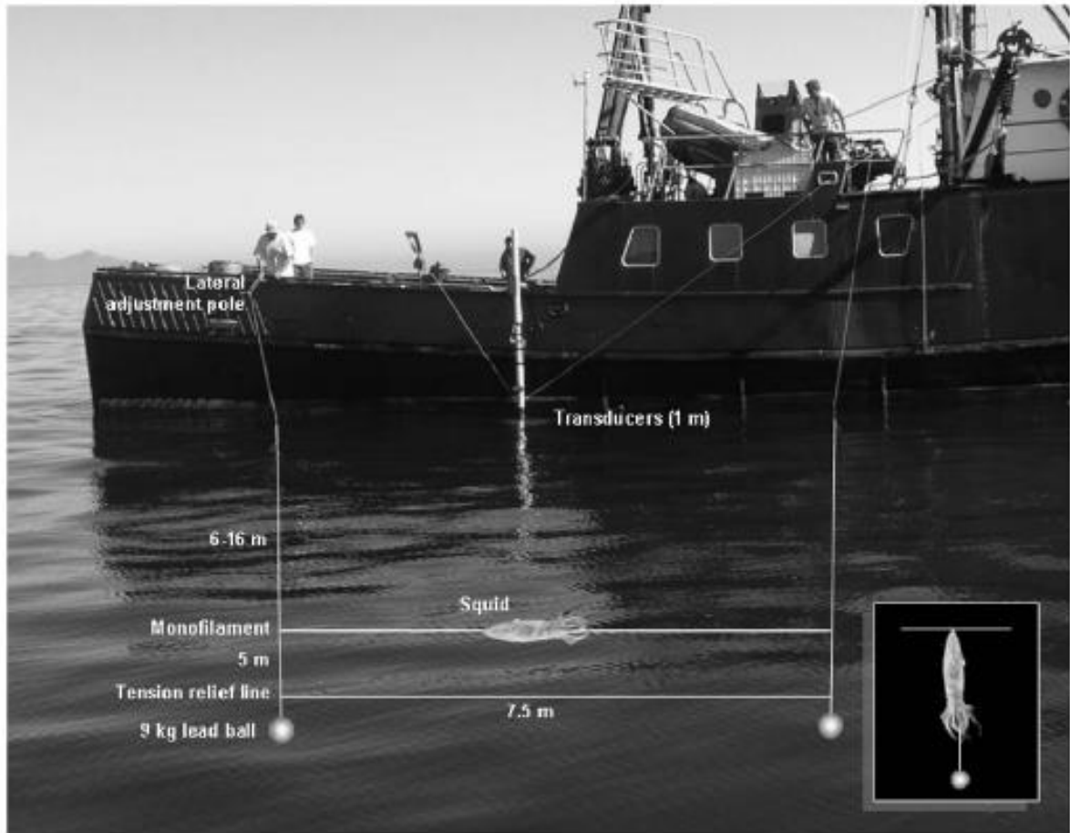
Figura 10.4. Esquema del experimento para la determinación de la fuerza de blanco de jibia (tomado de Benoit-Bird et al. , 2008).
