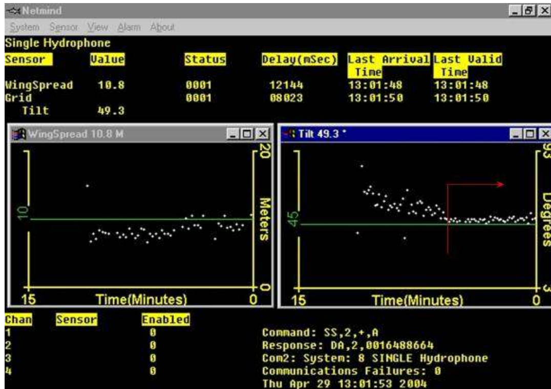
Fig. 1. Imagen de pantalla on line del sistema NETMIND utilizado para la estimación de apertura de punta de alas (APA). A la derecha, la línea roja vertical muestra el momento que se considera como t_1 de inicio del arrastre.
