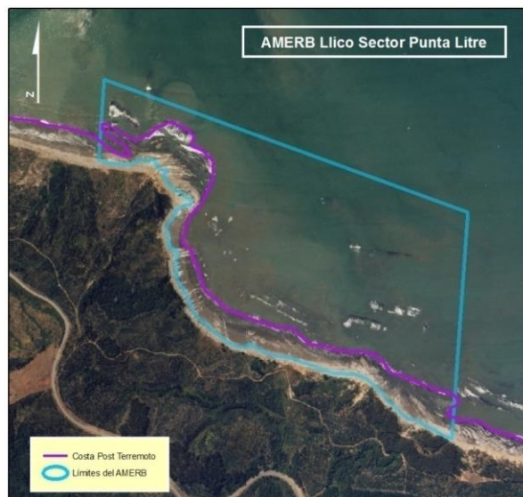
Fig. 194: Borde costero emergido en el AMERB Llico Sector Punta Litre. Obs. La fotografía de fondo es post terremoto. Se observa un desplazamiento relativamente parejo a lo largo de toda la línea de costa de la AMERB.
