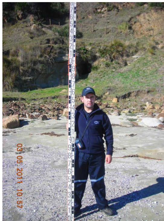
Fig. 6: Mira topogr3fica sobre la que se realiza la medici3n con el tel3metro.
