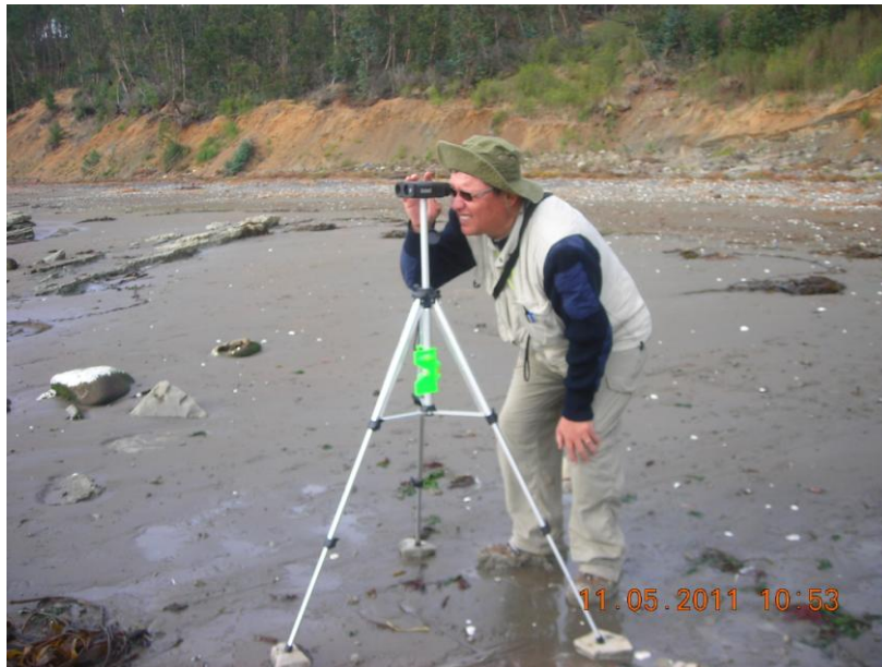
Fig. 5: Tel3metro laser utilizado para la medici3n de pendiente y distancia, con lo que se calcula la pendiente del sector.
