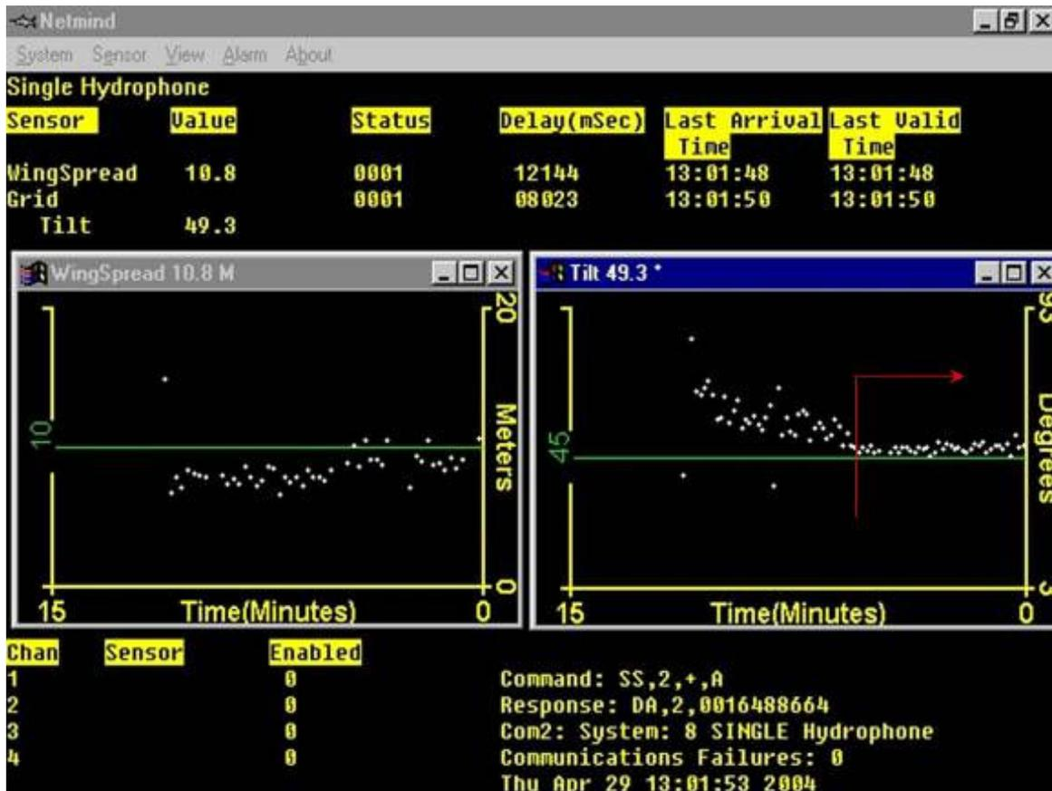
Fig. 1. Imagen de salida *on line* del sistema NETMIND utilizado para la estimación de apertura de punta de alas (APA). A la derecha, la flecha roja muestra el momento que se considera como  $t_1$  de inicio del arrastre.
