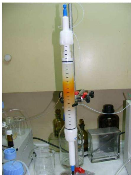
Figura 16. Purificación del compuesto amargo utilizando cromatografía SEC con fase estacionaria Sephadex LH-20 en columna cerrada. (Fuente: elaboración propia).
