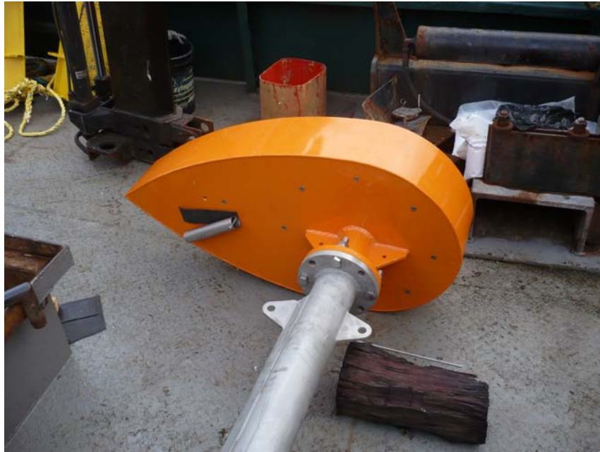
Figura 3: Parte del brazo y dispositivo de montaje de los transductores de 38 kHz y 120 kHz.
