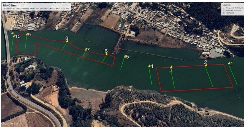
Figura 30. Transectas realizadas para la caracterización tipo de fondo y prospección de bancos naturales de recursos bentónicos sector Cáhuil, Estero la Palmilla.
