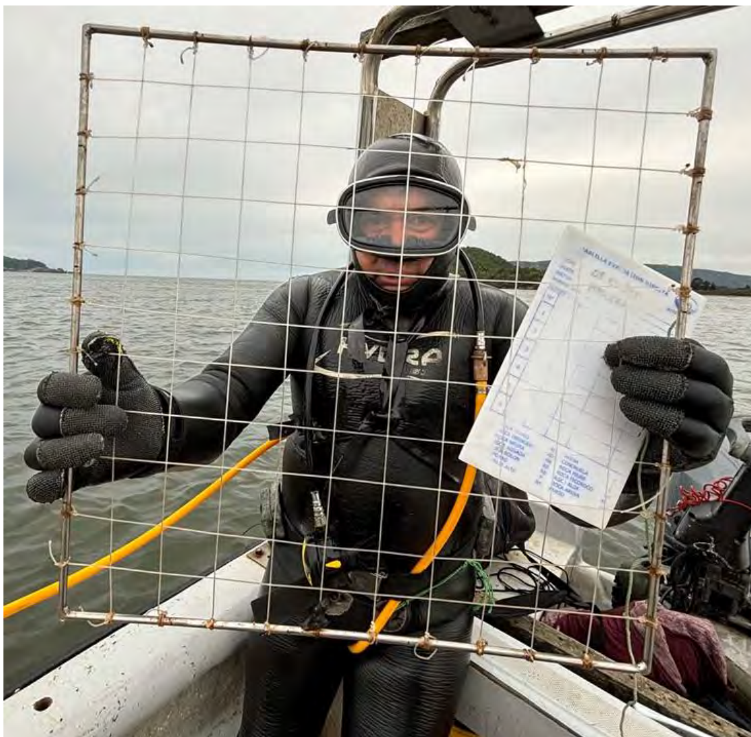
Figura 4: Fotografía de la unidad de muestreo utilizada para el muestreo poblacional, cuadrante de 0,250 m (0,5m * 0,5 m) con grilla de 100 puntos de intersección.
