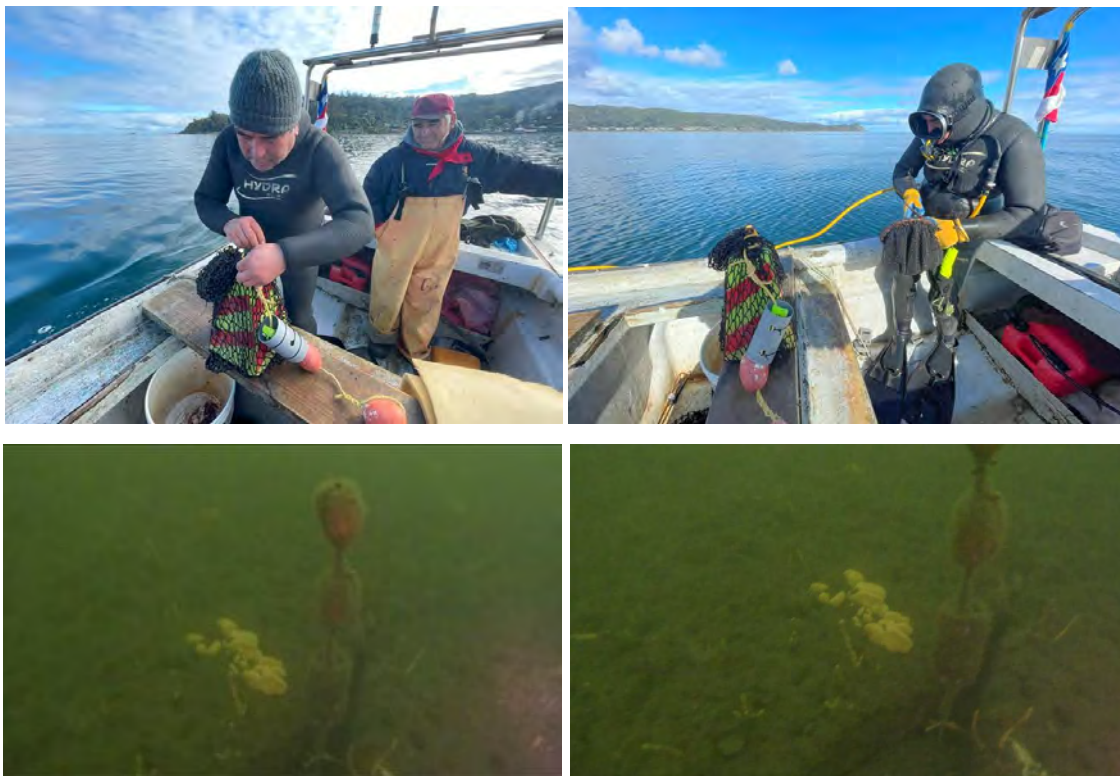
Figura 6: Fotografías durante la instalación del sensor HOBO, para medir la temperatura del mar a intervalos de una hora, en la Bahía de Corral, durante el período de muestreo (septiembre del 2023 – noviembre del 2024).
