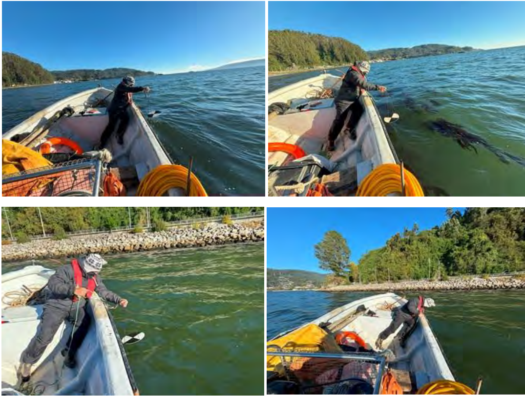
Figura 7: Mediciones de la turbidez mediante un disco Secchi, durante los muestreos poblacionales en la Bahía de Corral.
