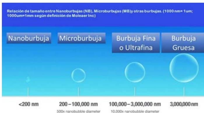
**Figura 30.** Relación de tamaño entre nanoburbujas (NB), microburbujas (MB) y otras burbujas. (1000 nm=1 µm; 1000 µm=1mm) según definición de Moleaer Inc.
