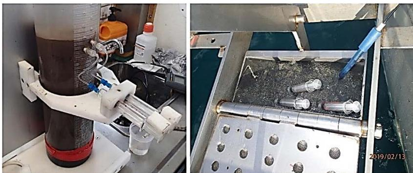
**Figura 13.** Método de extracción de agua intersticial de los cores en el monitoreo ambiental para sulfuros.
