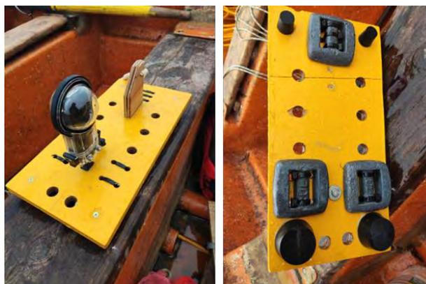
Figura 6. Plataforma de muestreo de peces con visualización panorámica de 360°. El panel derecho muestra el lado superior de la plataforma y el panel izquierdo muestra la parte inferior.
