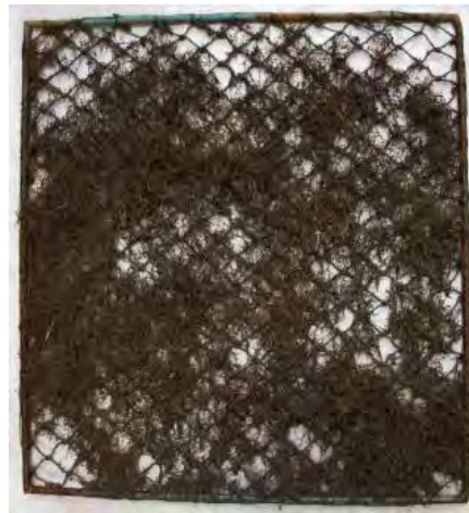
Figura 25 - Efectos de ensuciamiento de hidroides en una red de cultivo, Chun-Wei Bi et al., 2018
