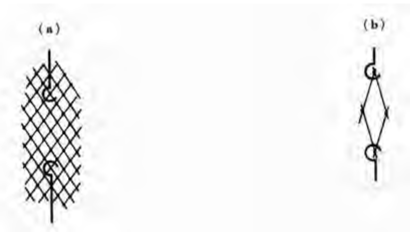
Figura 22 - Método de fijación para la prueba de ensayo de tracción de una red en forma de diamante
