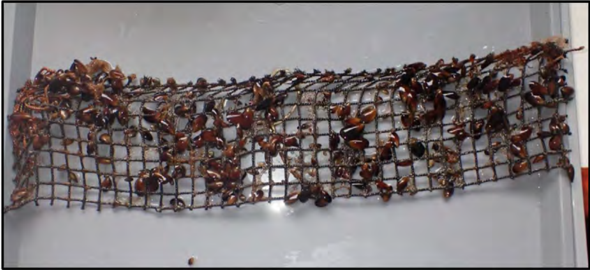
Figura 29 -Fotografía de la muestra 2 de la malla T1 con una cobertura del 60% de Mytilus sp.
