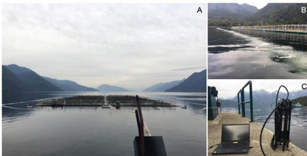
Figura 22: Centro Caleta Soledad (A), con un sistema de cortinas de burbujas (B) y equipo FRRF3 para medir la eficiencia fotosintética de los organismos fitoplanctónicos (C).
