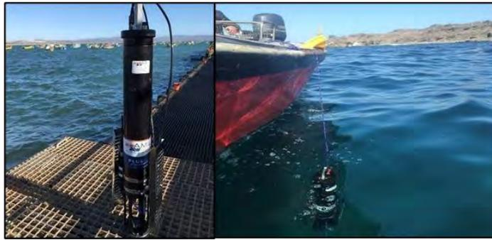
Figura 88. CTDO marca AML modelo Plus-X
