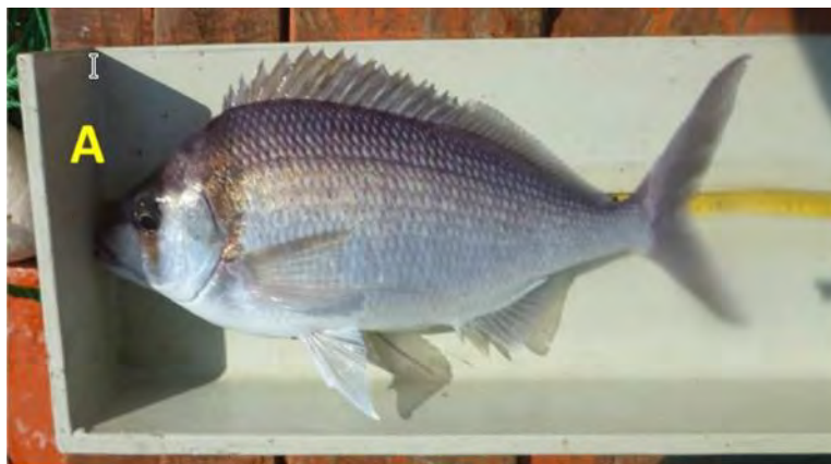
Figura 2. Ictiómetro utilizado para medir peces (breca en la figura) en el archipiélago Juan Fernández
