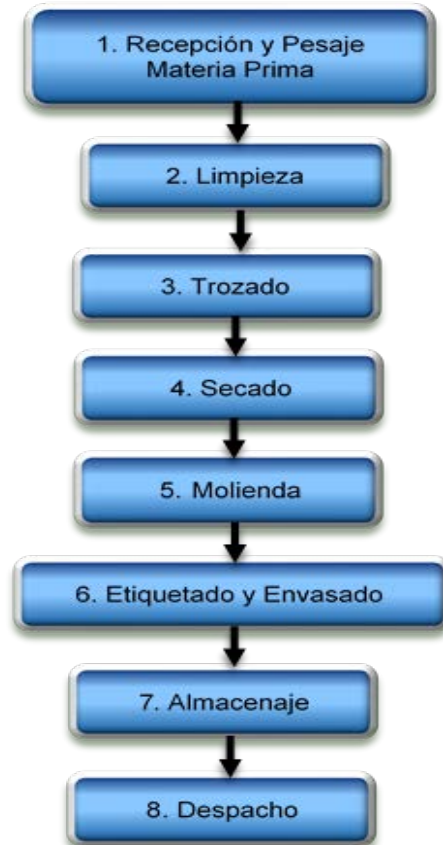
Figura 259 Flujograma de proceso de deshidratado de macroalgas Fuente: Elaboración propia
