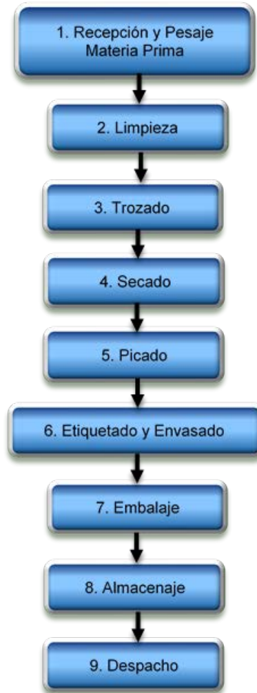
Figura 252 Flujograma de proceso de deshidratado de macroalgas Fuente: Elaboración propia
