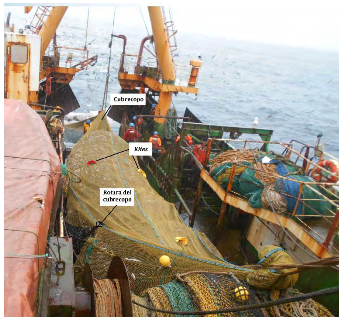
Figura 12. Fotografía de cubierta durante un lance usando el método de copo cubierto para la estimación de selectividad a bordo del PAM Bonn.
