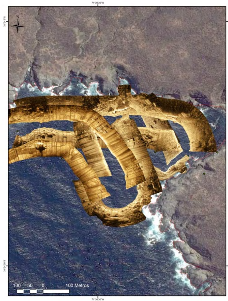
Figura 6. Imagen Raster del tipo de sustrato registrado mediante la utilización de Side scan.
