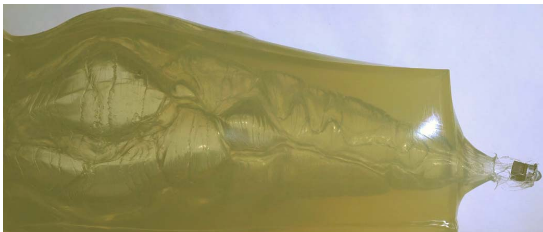
Fig. 2 Fotografía de alta velocidad de munición tipo brenneke atravesando 16 pulgadas de gel balístico, según protocolos del FBI.
