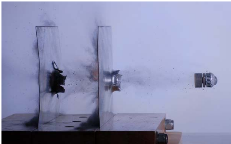
Fig. 1 Fotografía de alta velocidad de munición tipo brenneke perforando láminas de acero 20-Gauge, según protocolos del FBI.
