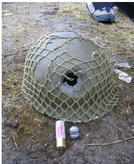
Fig. 3 Casco militar modelo M1 de acero perforado con slug tipo brenneke marca Rottweil, calibre 12. Distancia de tiro: 20 metros.
