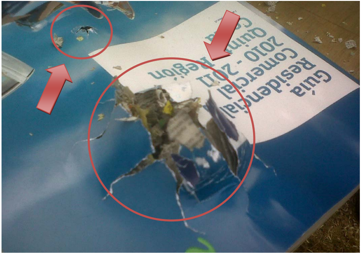
Comparación impactos munición 7,61x51 v/s brenneke al traspasar los bloques de papel.
