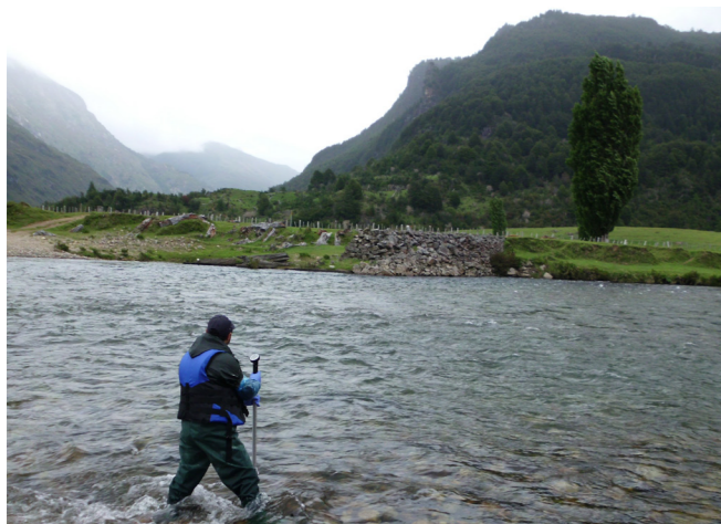
Figura 7. Medición de velocidad de corriente utilizando flujómetro
