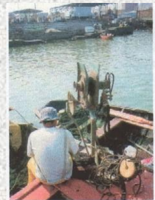
Virador hidráulico de redes
