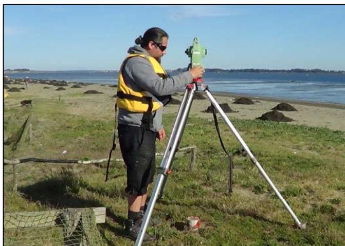
Foto 20. Instrumental Topográfico sobre un vértice base.
