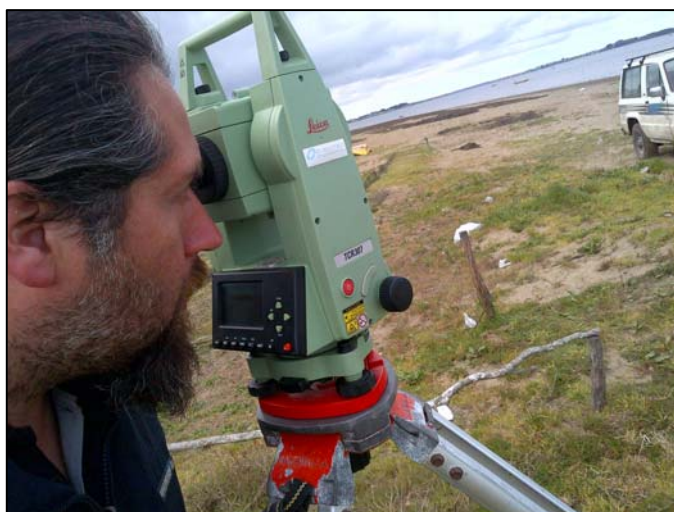
Foto 22. Medición de coordenadas con Estación Total.
