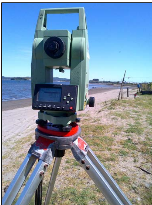
Foto 24. Estación Total utilizada para replanteo de parcelas.
