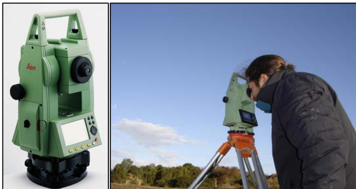
Foto 17. Estación Total para replanteo y medida de ángulos y distancias.
