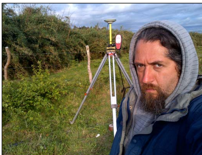
Foto 21. Instalación de GPS diferencial sobre un Vértice Base
