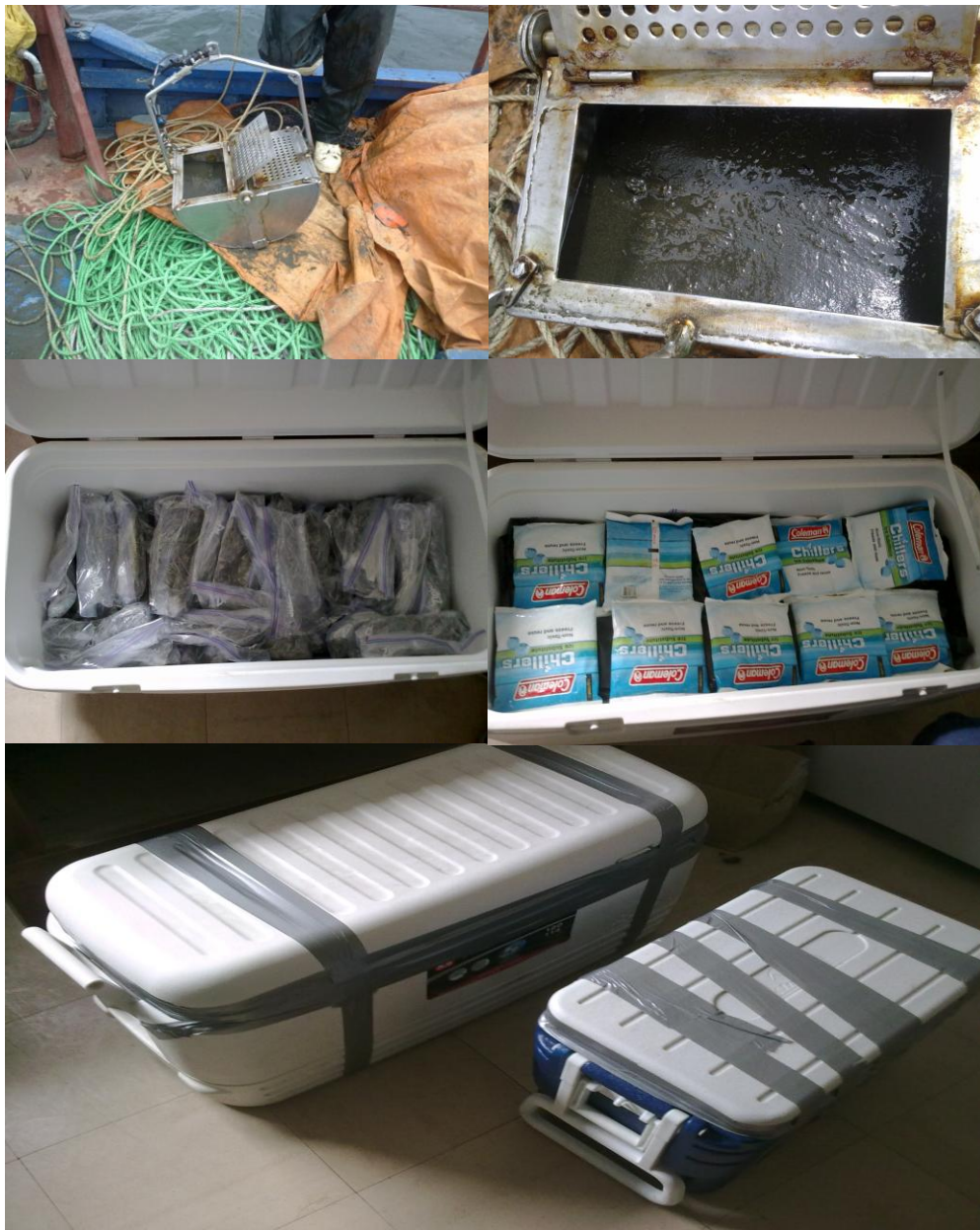
Figura 2.3. Secuencia fotográfica del muestreo de sedimentos y su posterior embalamiento para su envío a CESMEC.
