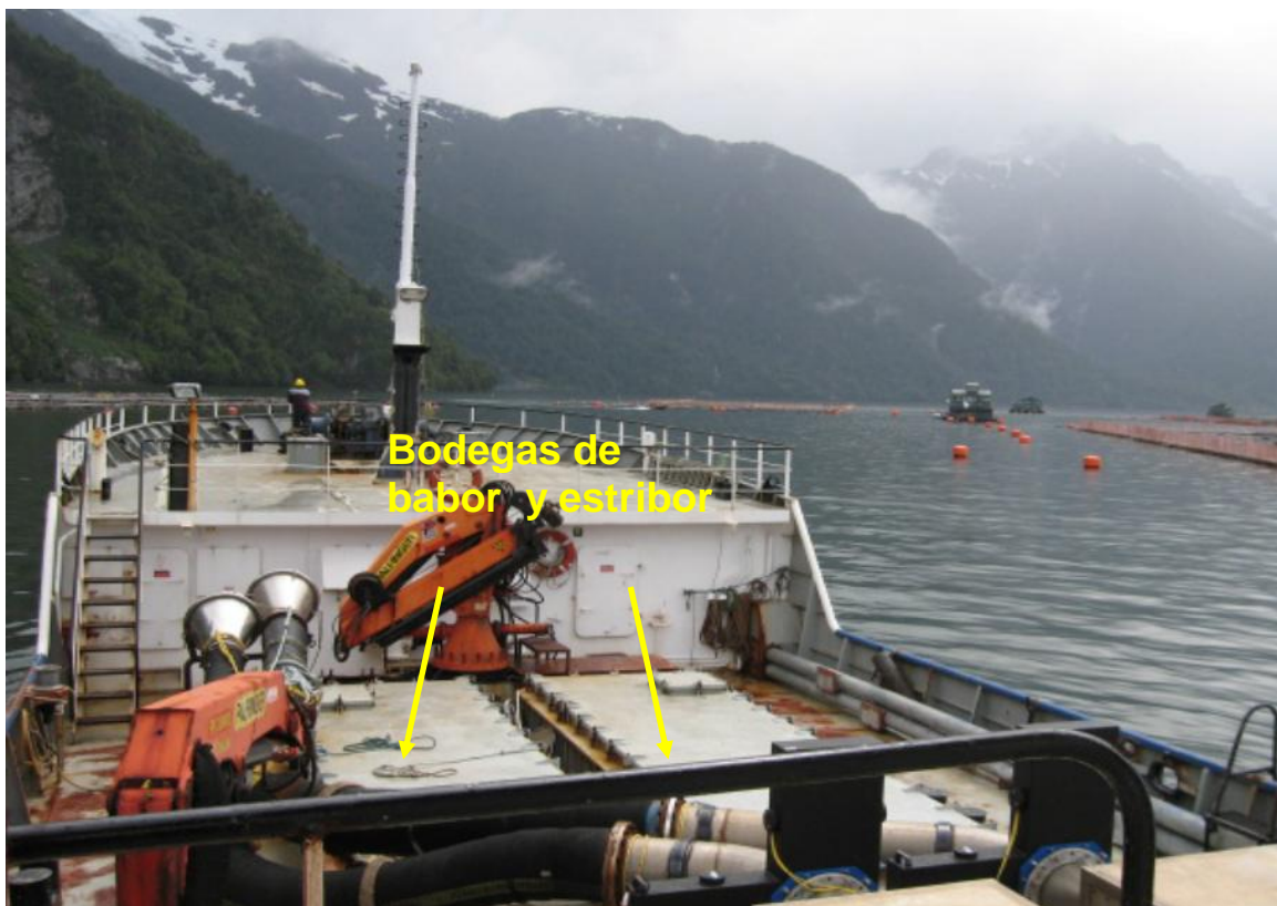
Figura 16. Bodegas de babor y estribor de la nave Patag3n IV utilizadas para el transporte de peces vivos (Foto: Nicole Pesse).
