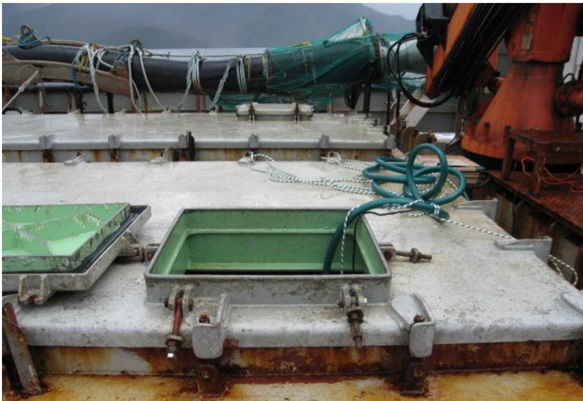
Figura 22. Compuerta de acceso al interior de la bodega de estribor. Se muestra la manguera de succi3n de agua y cabo que sostiene la bomba sumergible a 5.5 m de profundidad de la bodega cargada con peces vivos (Fotos: Nicole Pesse).
