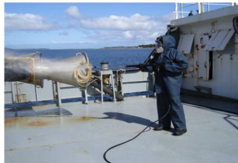
Imagen 04. Lavado de cubierta principal de la nave.
