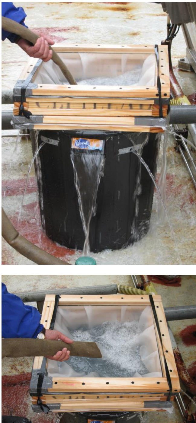
Figura 24. La foto superior muestra el sistema de filtraci3n de agua del exterior. La foto inferior muestra un detalle del set de tamices dispuestos de mayor a menor trama de la malla y sumergimiento de las mismas, utilizados para la recolecta de muestras de agua (Fotos: Nicole Pesse).
