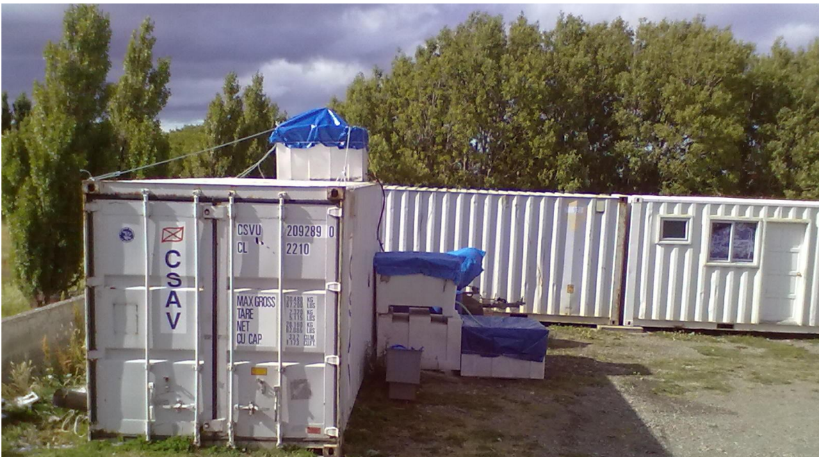
Figura 13. Sistema a escala piloto de desarenado utilizado para realizar la experiencia de validaci3n de muestreo y tratamiento para la eliminaci3n de A. catenella implementados en plantas de desarenado o desinfecci3n.
