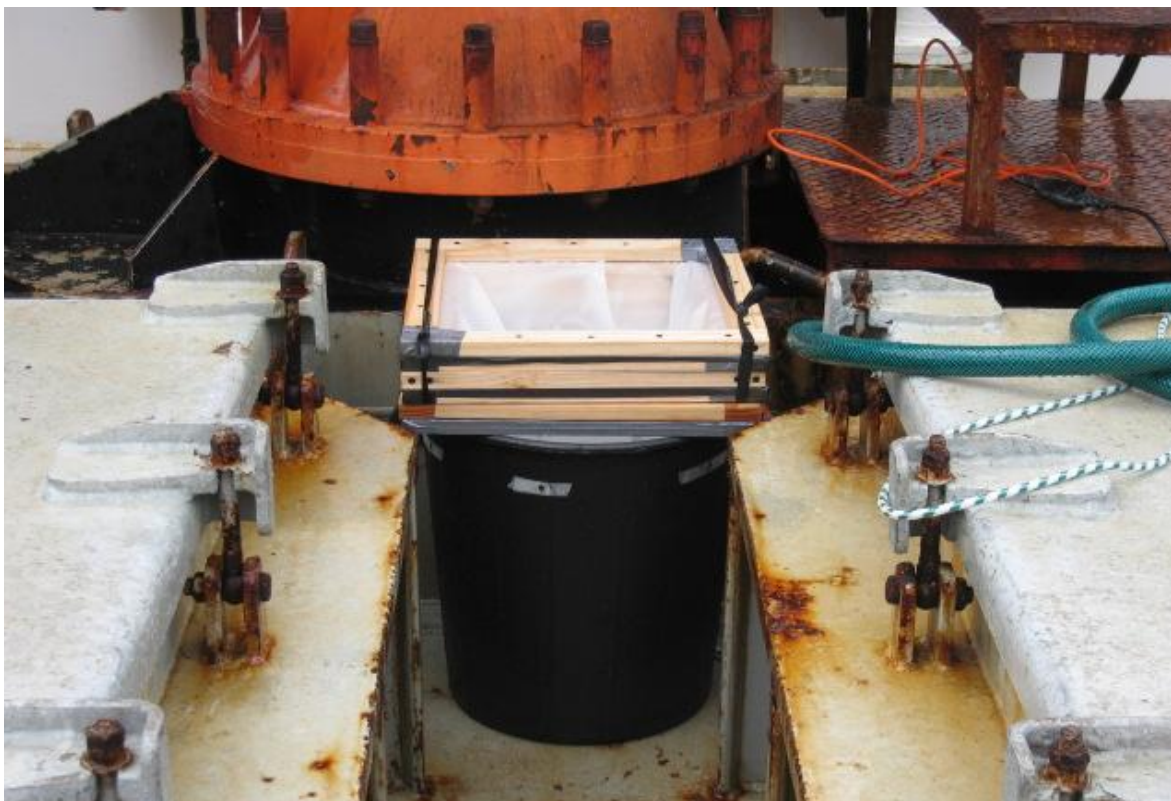
Figura 23. Sistema de tamices (superior 250, centro 100 y abajo 20 \mu\text{m} , respectivamente) utilizados para filtrar el agua proveniente de la bodega cargada con peces vivos (Foto: Nicole Pesse).
