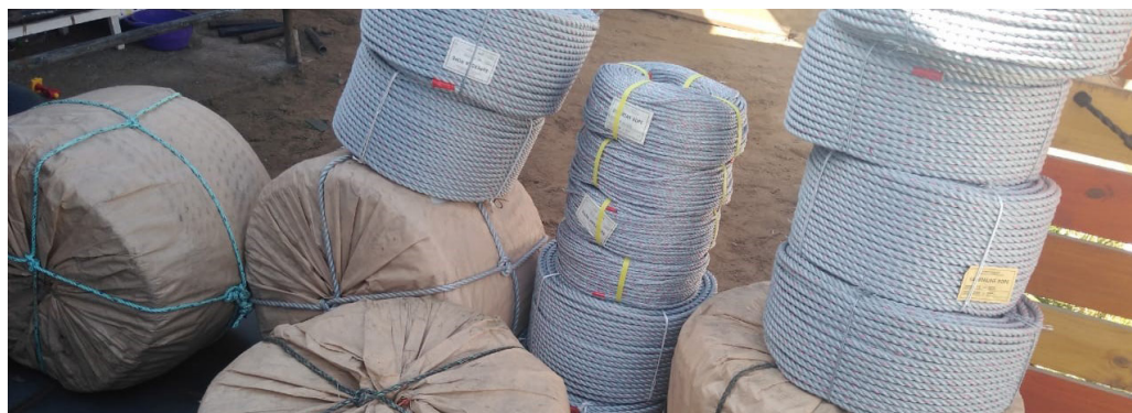
FIGURA 6 Cabos de polipropileno
