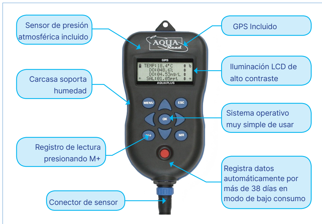
FIGURA 26 Componentes del Multiparámetro Aquaplus
