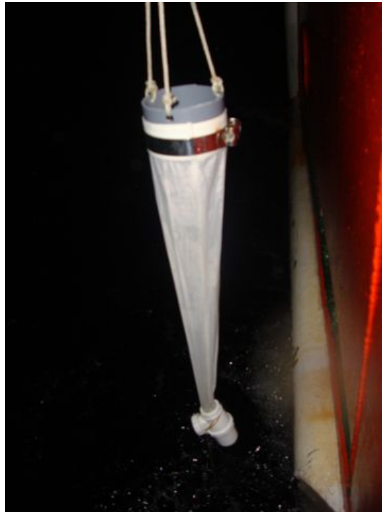
Figura 2. Red de 23 micras de muestreo de arrastre para recolecta de fitoplancton de los 20 m superficiales
