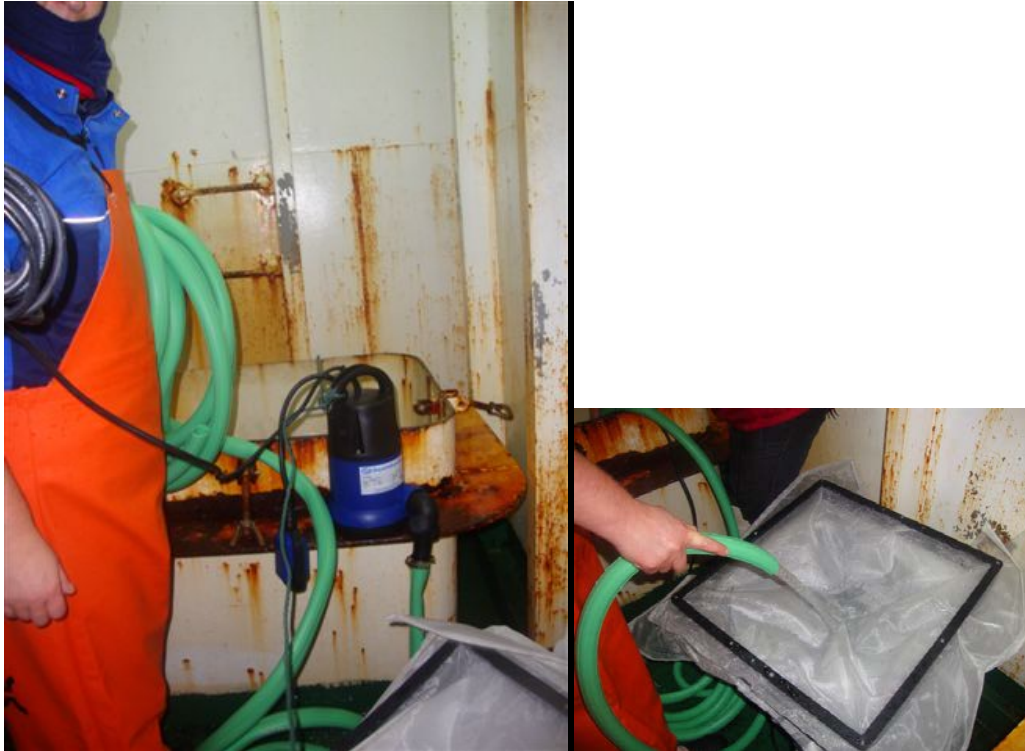
Figura 7. Derecha, bomba el3ctrica utilizada para la recolecta de agua desde la bodega de proa con acoplamiento de manguera. Bomba se encuentra en la compuerta de entrada a la bodega. Izquierda, recepci3n de agua succionada por la bomba desde la bodega sobre los tamices.
