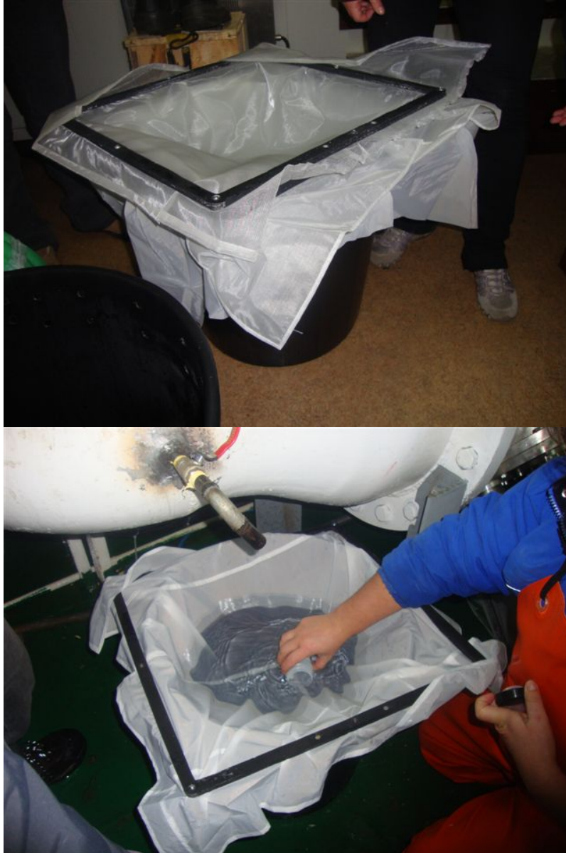
Figura 5. Tamices confeccionados con red de 200, 110 y 23 \mu\text{m} , dispuestos sobre un receptor de agua de 55 L para el muestreo realizado en las diferentes secciones de la nave.
