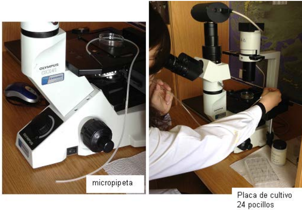
Figura 6. Aislamiento manual mediante micropipeteo bajo un microscopio invertido, de c3lulas de A. catenella y otras microalgas presentes en las muestras de agua de fitoplancton vivo.
