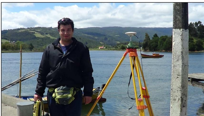
Foto 15. GPS diferencial sobre un Vértice Base en sector río Mehuin.
