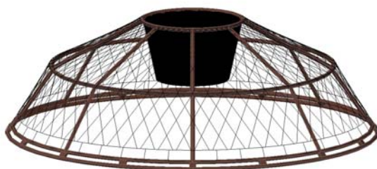
Figura 14. Trampa con un panel de mallas rectangulares en el perímetro inferior. Esto se logra con el corte de una barra que separa dos mallas cuadradas consecutivas).
