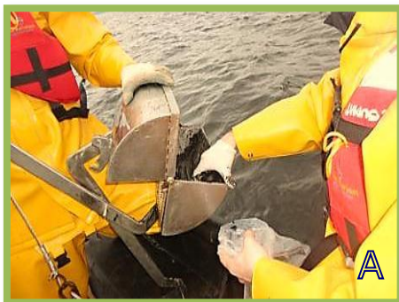
FIGURA 2.- A: Uso de draga en la toma muestras de sedimento. B: Armado de trampas de sedimento. C: Medición de variables físico-químicas del sedimento.
