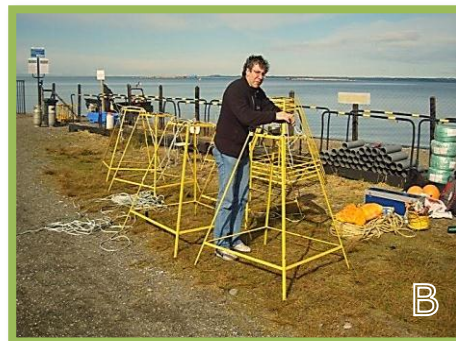
FIGURA 2.- A: Uso de draga en la toma muestras de sedimento. B: Armado de trampas de sedimento. C: Medición de variables físico-químicas del sedimento.
