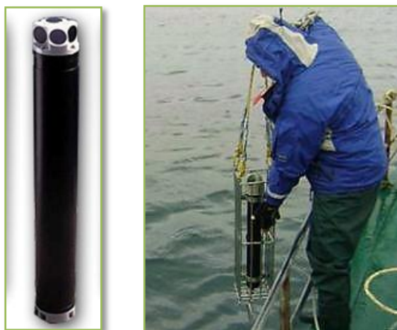
FIGURA N°3.- Correntómetro ADCP utilizado en el estudio.
