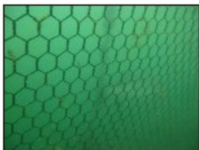
Figura 9. Imágenes del estado de redes, antes y después de la aplicaci3n de la limpieza por chorro de agua a alta presi3n.
