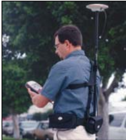
Foto 11. GPS Leica GS20 usado como móvil modo RTK
