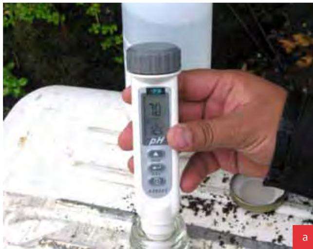
Figura 5 a: calibración de pHímetro
