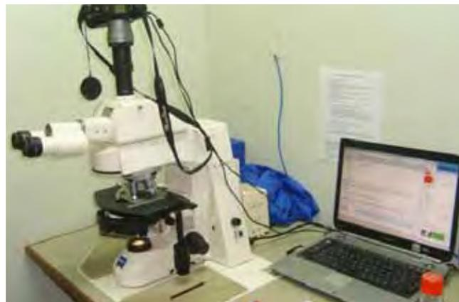
Figura 37. Microscopio óptico con sistema de captura de imágenes y análisis digital incorporado.
