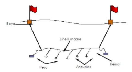
Figura 1: Esquema del espinel horizontal demersal.
