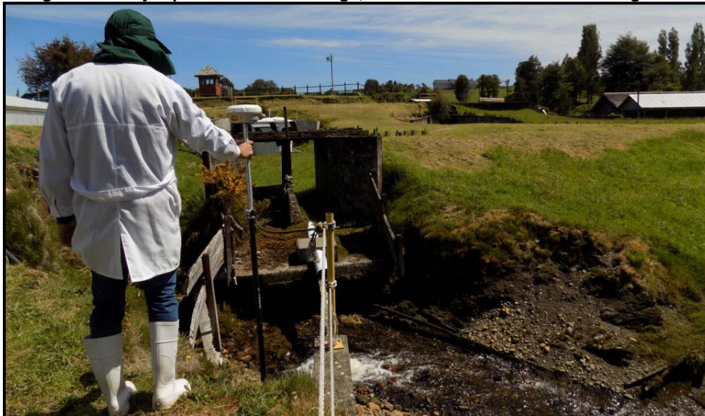
Figura N°34. Ejemplo Medición Descarga, Piscicultura Astillero. Fuente: Ingeland.
