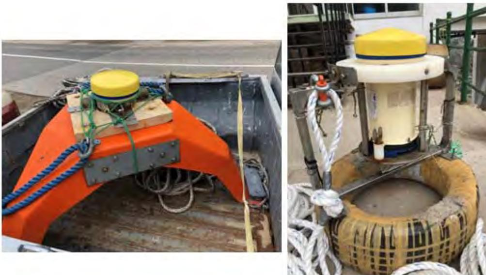
**Figura 8.** Estructura de instalación del ADCP utilizadas en los anclajes: tipo trípode (en Los Molles, Maitencillo, Punta Ángeles) y tipo peso circular con sistema basculante (en Laguna Verde). FIPA 2017-18.
