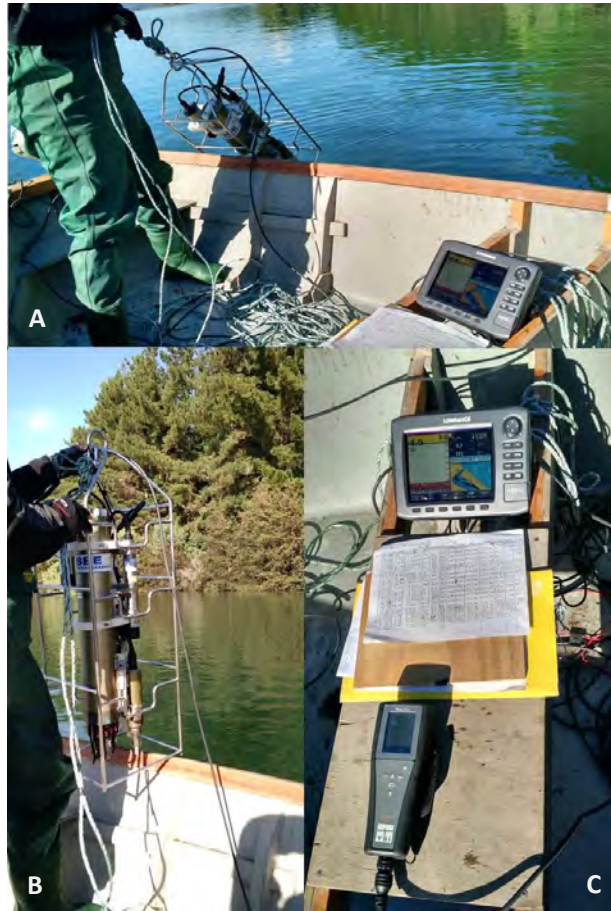
Figura 10. Equipos oceanográficos usados en las estaciones muestreadas: A, B y C (superior), perfilador de Conductividad-Temperatura-Profundidad (CTD); C (inferior), sonda multiparámetro.
