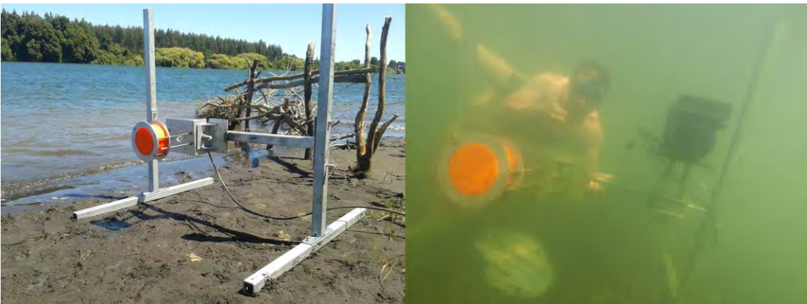
Figura 24. Frame utilizado para el montaje de ambos equipos acústicos y a la derecha se observa el funcionamiento de ambos equipos sumergido en el agua.
