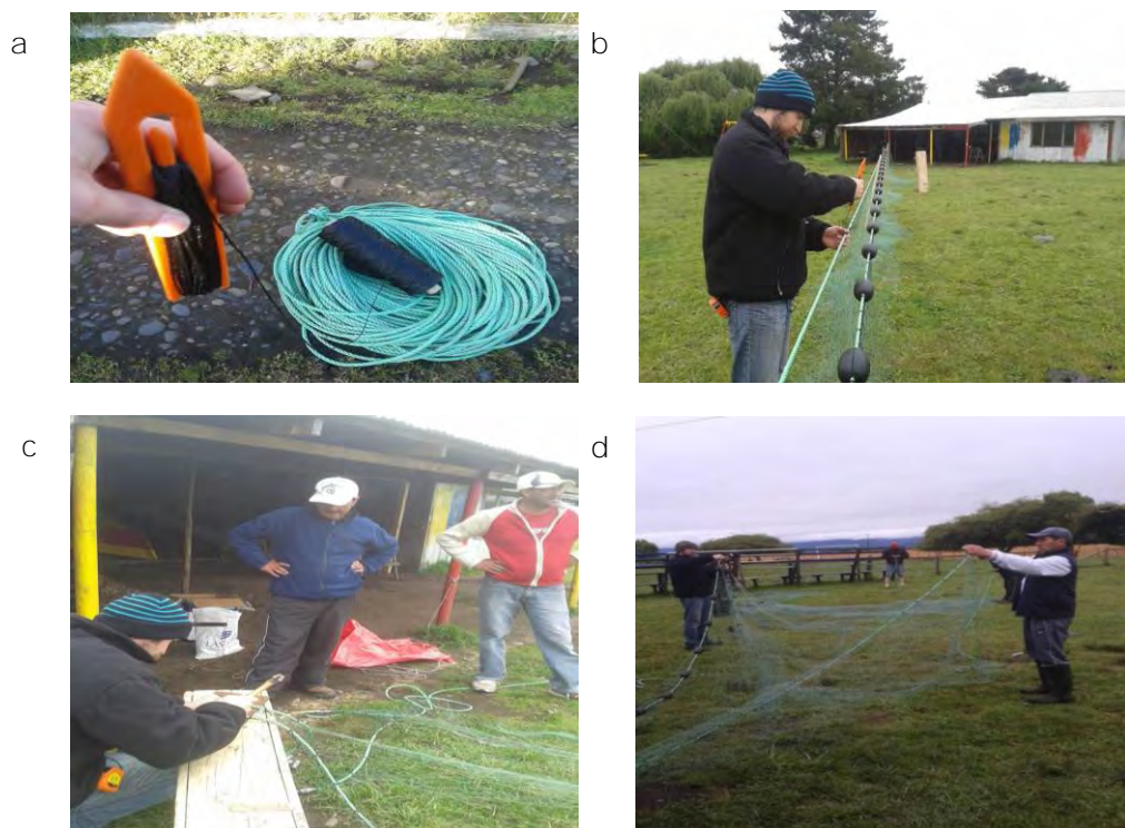
Figura 18. Proceso de armado de redes de enmalle: Agujas de plástico para enhebrar hilo negro (a); encabalgado de la red (b); instalación de los plomos en la red (c) y despliegue de la red (d).
