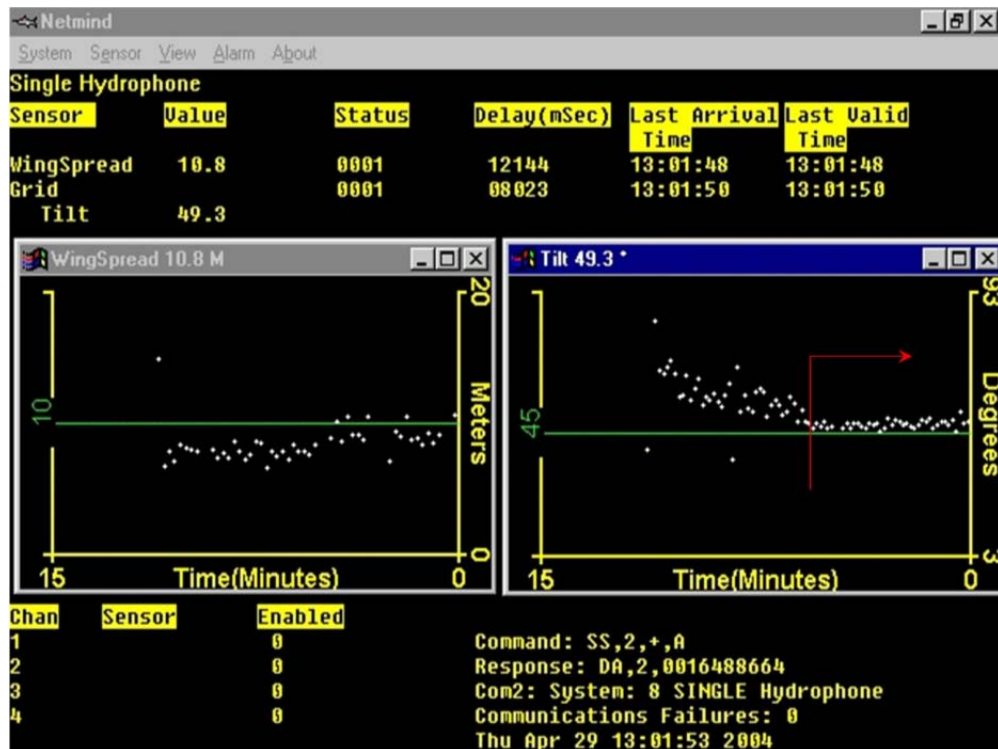
Fig. 1. Imagen de salida on line del sistema NETMIND utilizado para la estimación de apertura de punta de alas (APA). A la derecha, la línea vertical roja muestra el momento que se considera como t_1 de inicio del arrastre.
