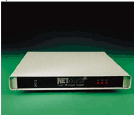
Equipo Wing Spread Netmind de North Star Technical. (a) Deck Unit de conexión entre el hidrófono y el PC; (b) hidrófono de remolque; (c) Sensores de apertura de alas.
