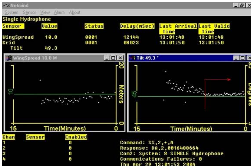
Fig. 1. Imagen de salida on line del sistema NETMIND utilizado para la estimación de apertura de punta de alas (APA). A la derecha, la flecha roja muestra el momento que se considera como t_1 de inicio del arrastre.
