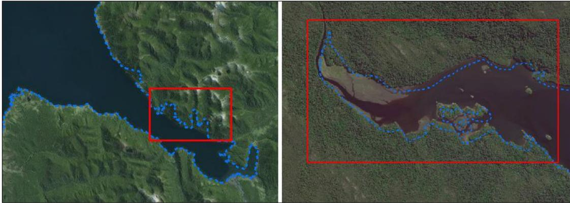
Figura 21. Ejemplos de errores en base cartográfica IGM 1:50.000
