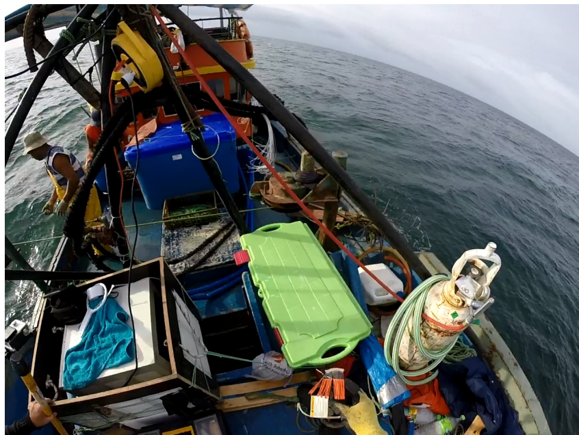
Figura 6.33. Disposición final del sistema de reanimación y de sus componentes en la embarcación La Esperanza . Se observa el estanque al centro, el chiller y cilindro de oxígeno a proa
