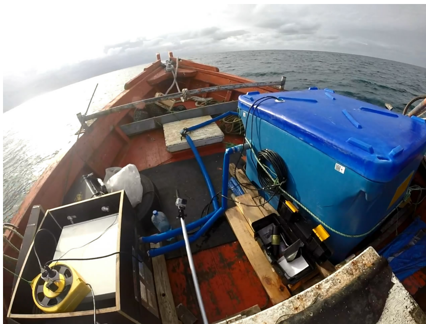
Figura 6.29. Disposición del sistema de reanimación en la sección de proa de la lancha Surazo .
